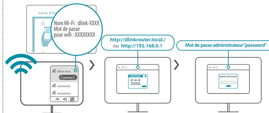
**Conseil technique :** Pensez à utiliser le même nom Wi-Fi et le même mot de passe Wi-Fi que votre ancien routeur. Cela permettra à vos appareils Wi-Fi existants de se connecter automatiquement à votre nouveau routeur.
